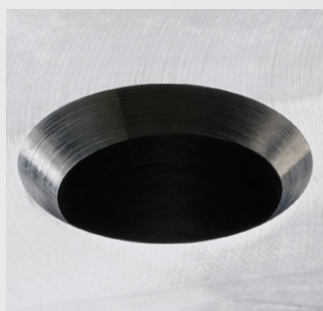
Svasatura con svasatori cilindrici a taglienti elicoidali
