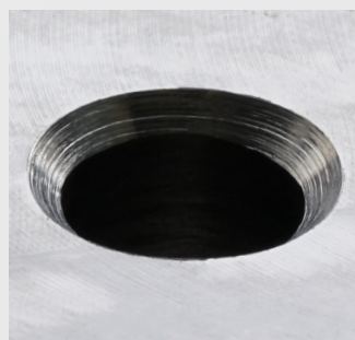
Svasatura con svasatore cilindrico standard
