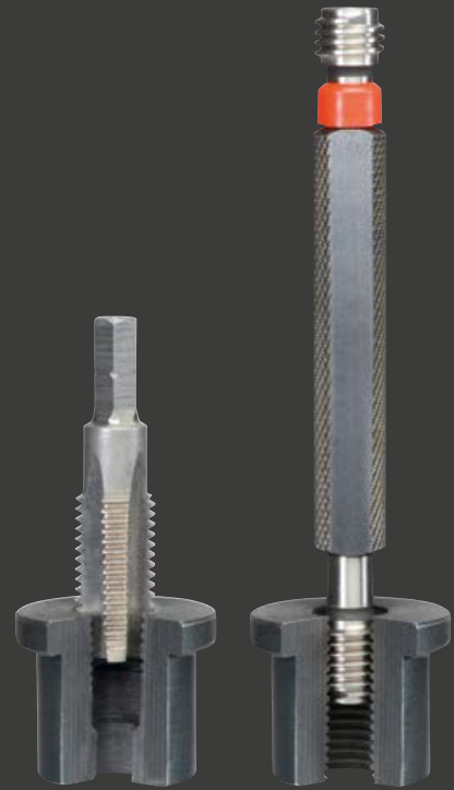
Prüfung eines mit einem STI-Gewindebohrer geschnittenen Aufnahmegewindes mittels STI-Präzisions-Gewindelehrdorn - vor dem Verbau des V-COIL Gewindeeinsatzes.
