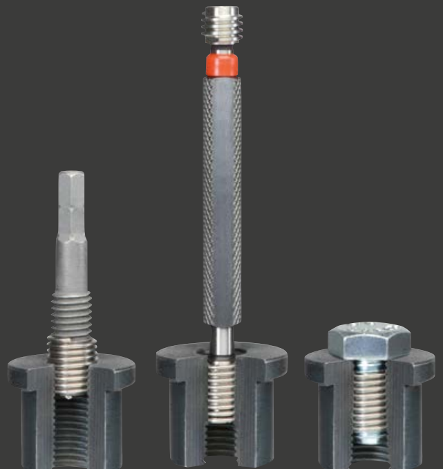
Prüfung der Maßhaltigkeit eines in das Aufnahme-gewinde verbauten V-COIL Gewindeeinsatzes mit einem Präzisions-Gewindelehrdorn für Standardgewinde
