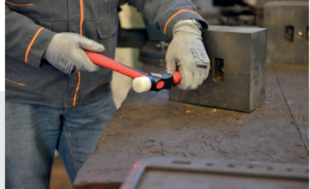
Richten mit der Schonhammerseite, ohne dabei etwas zu beschädigen Adjustment with the soft-face side without any damage
